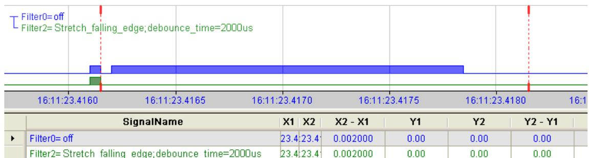
Figure 7: Debounce filter: „Stretch falling edge“
